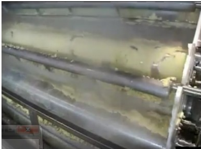
Etape de pressage et séchage de la purée.
