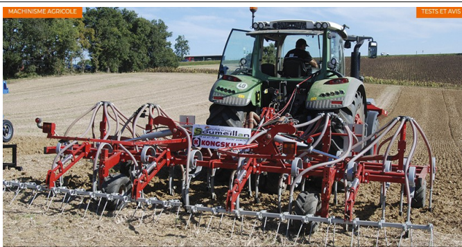
Semoir à dents avec trémie à l'avant.
