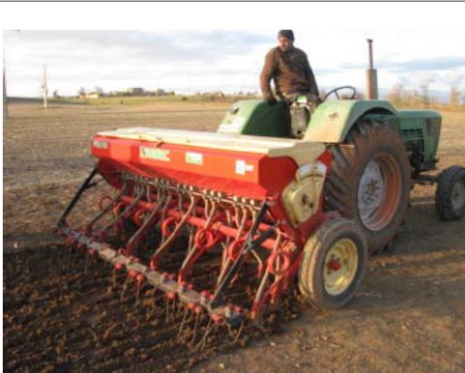
Semoir Agric S.A. conventionnel testé sur un sol non labouré pour déterminer la capacité de semis des dents.
