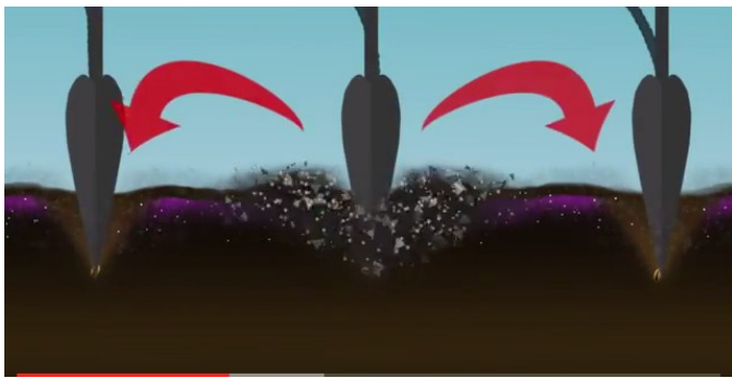
Passage du semoir à grande vitesse, de la terre et de l'herbicide est projetée sur les rayons adjacents.
