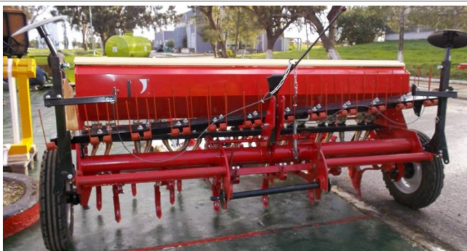
Le semoir conventionnel CMA-SOLA comporte une herse de recouvrement (ici sur l'aire de stationnement, la herse n'est pas positionnée à sa place).
