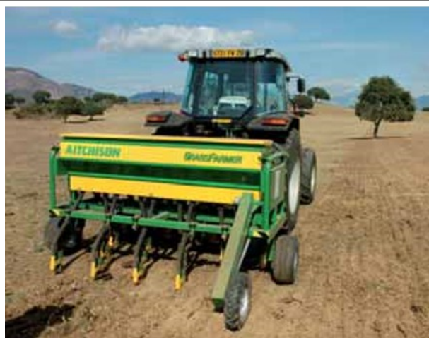
Semis direct avec des dents en forme de « T » renversé..
