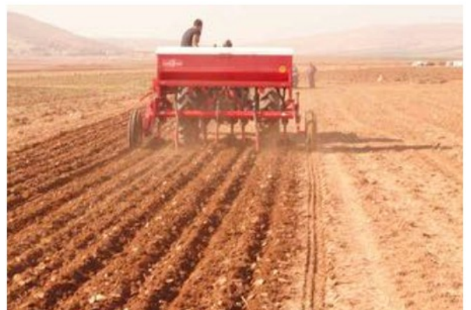
Irrégularité des sillons. La trop grande vitesse entraîne la projection de terre dans les sillons latéraux .
