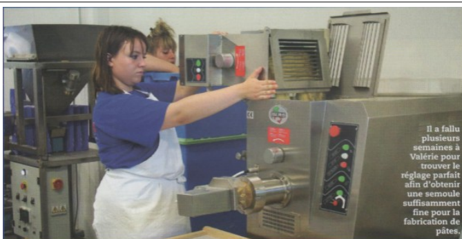
Atelier de fabrication de pâtes alimentaires à la ferme (l'extrudeuse)
