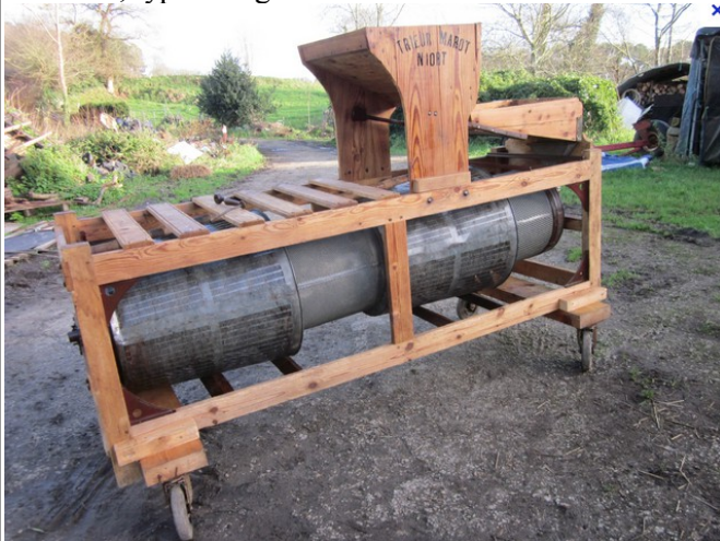
Trieur à céréales traditionnel (cfcai.com)
