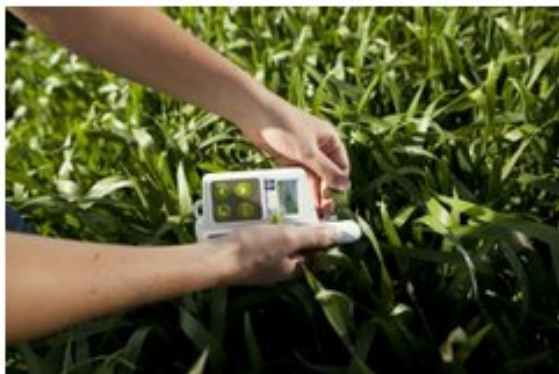
L'Inra propose d'utiliser des pinces de type Hydro-N-Tester pour se renseigner sur le niveau de besoin du blé en azote en cours de campagne. - © Yara
