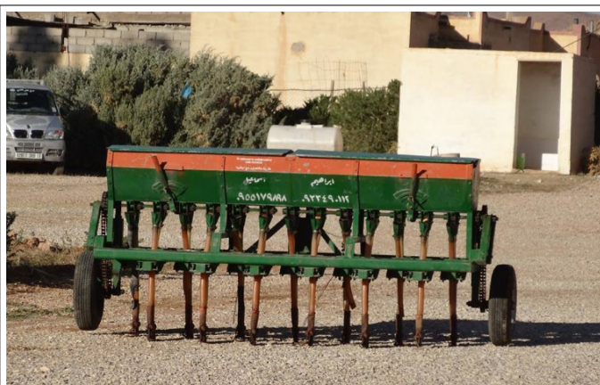
Le semoir pour semis direct (Aschbal Syrie)
