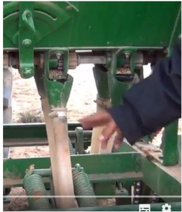
On voit clairement 2 tubes de descente : un pour les semences et l'autre pour les engrais.
