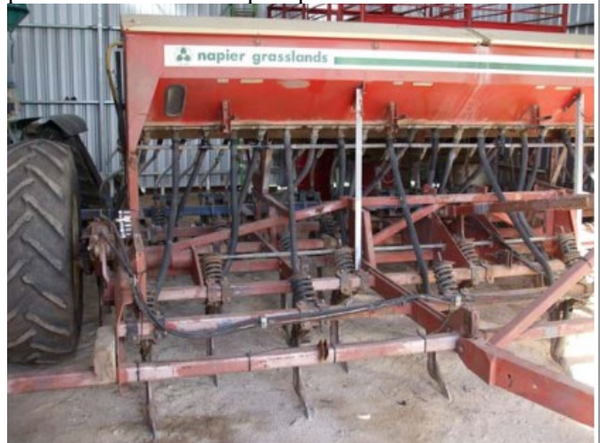
Une trémie sur-élevée pour faciliter la descente des semences et engrais par gravité
