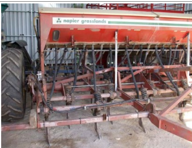
La trémie est surélevée afin de faciliter la descente des engrais et semences par gravité.
