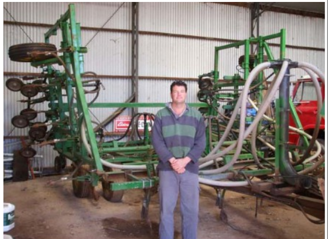
Chris devant le châssis du cultivateur transformé en semoir pour semis direct.
