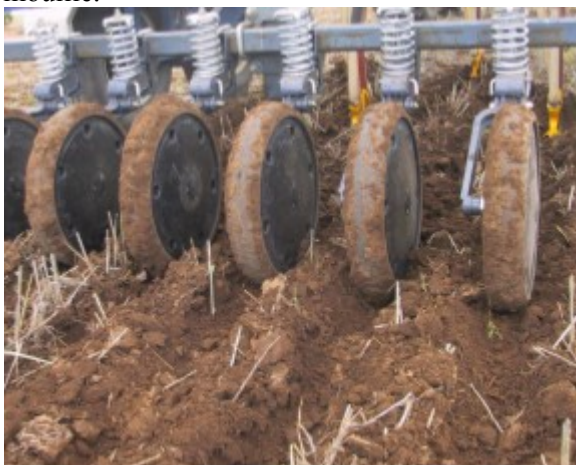
Roues plombeuses rappuyant la terre au fond de chaque sillon. En conditions humides, l'existence d'un décrotoir permet d'enlever la terre qui adhère aux roues.
