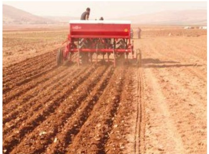
Absence de certains sillons suite à une trop grande vitesse du tracteur (ICARDA Alep).
