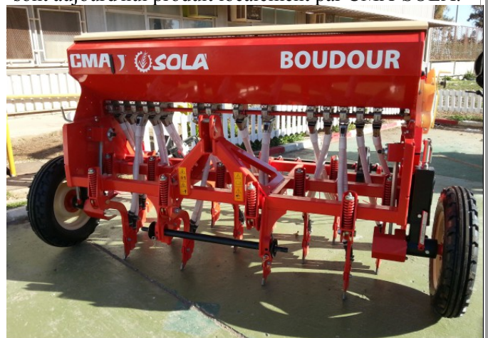
Semoir algérien low-cost pour semis direct.
